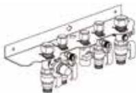
Set valvole EKKV comprensivo di piastra/dima di fissaggio a muro, rubinetti di intercettazione, rubinetto di caricamento circuito di riscaldamento, valvola di svuotamento circuito di riscaldamento e valvola di sovrappressione da 3Bar
