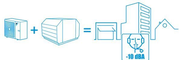
Cover fonoassorbente che soddisfa severi **requisiti acustici**, aumentando la **flessibilità** nell'applicazione delle pompe di calore **Sky Air Alpha RZAG-N**, **Advance Package RZA-D** e **Mini VRV 5 RXYS-A**
