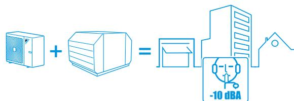
Cover fonoassorbente che soddisfa severi **requisiti acustici**, aumentando la **flessibilità** nell'applicazione delle pompe di calore **Sky Air Alpha RZAG-N**, **Advance Package RZA-D** e **Mini VRV 5 RXYSA-A**
