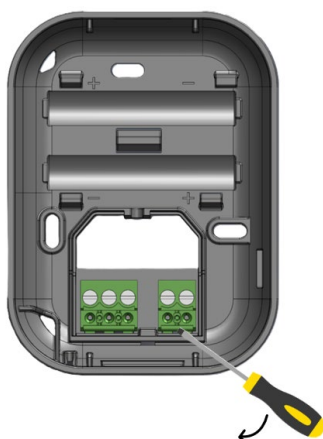
Figura 12 Sgancio connettore Sensore ON/OFF - OT
