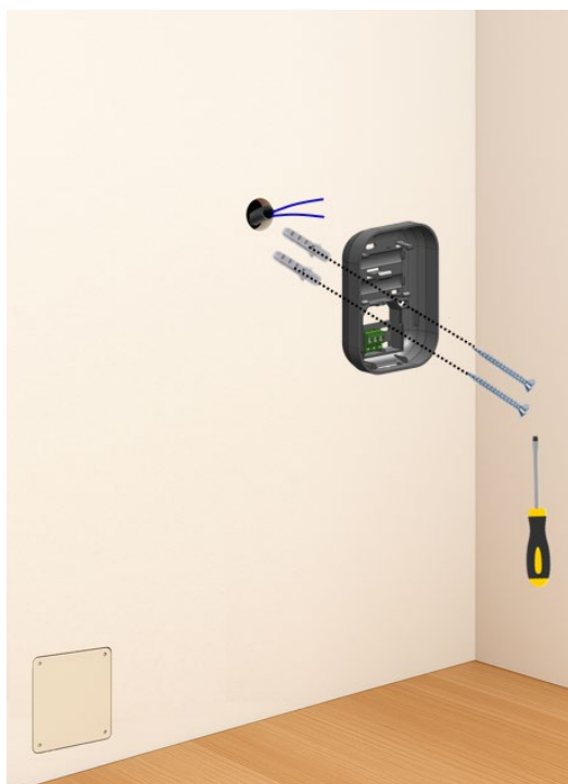
Figura 10 Fissaggio Sensore ON/OFF - OT a muro
