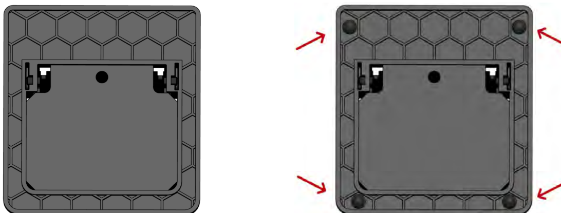
Figura 4 Applicazione gommini antiscivolo
