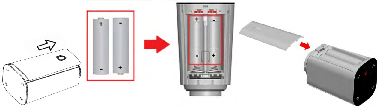
Figura 23 Inserzione batterie attuatore smart (Attenzione: verificare corretta polarità)
