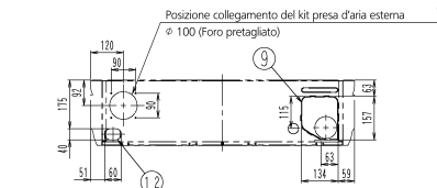
Posizione del foro per l'uscita delle tubazioni dal lato posteriore (Vista frontale)
