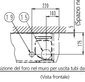
Posizione del foro per l'uscita delle tubazioni dal lato posteriore (Vista frontale)
