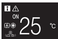
L'intervallo dei setpoint predefinito è 16°C~32°C. Se vengono impostati limiti a questo intervallo mediante l'apposita funzione dell'intervallo dei setpoint (funzione dell'app Madoka Assistant; vedere "Intervallo dei setpoint" [▶ 116]), è possibile solo aumentare o diminuire il setpoint per impostare i limiti massimi/minimi dell'intervallo.
