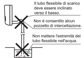
2) Rimuovere i filtri dell'aria e versare un po' d'acqua nella vaschetta di scarico per controllare che l'acqua scorra in modo fluido.
