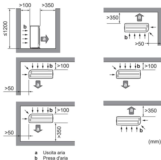
Lasciare 300 mm di spazio sotto la superficie del soffitto e 250 mm per la manutenzione di tubi e cavi elettrici.
