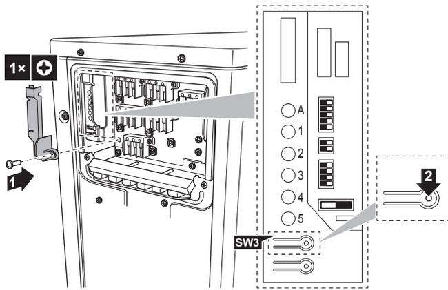
2 Premere brevemente l'interruttore di controllo degli errori di cablaggio (SW3) sulla scheda PCB di servizio dell'unità esterna.
