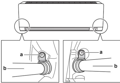
a Vite di fissaggio dell'isolante
