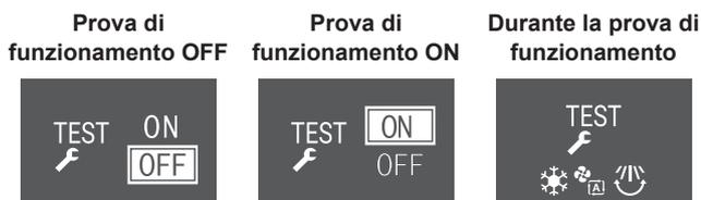
**Risultato:** La prova di funzionamento si arresta automaticamente dopo 30 minuti circa.
