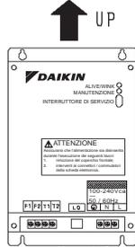
Assicurarsi di installare l'unità verticalmente. Un'installazione orizzontale potrebbe comportare un funzionamento non corretto.
