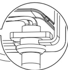
Controllare che il cavo di connessione sia saldamente assicurato.
