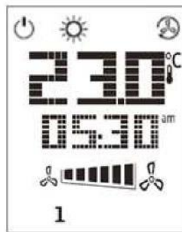
Modalità Ventilazione, riscaldamento
