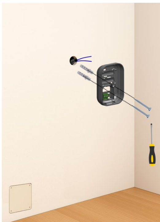
Figura 10 Fissaggio Sensore ON/OFF - OT a muro
