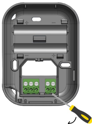
Figura 12 Sgancio connettore Sensore ON/OFF - OT
