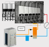
Centralizzati SIC Small inverter chiller con caldaie modulari
